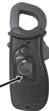
クリップ (これを動かして電池の交換ができます)
